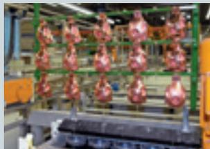
Veredelung von Bauteilen durch Galvanisierung: In der automatischen Galvanoanlage wird Wasser aus einem geschlossenen Kreislauf für die einzelnen Prozessschritte verwendet.
