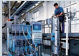
Das Misch- und Messsystem imprägniert die Isolierplatten und -rohre – Teile, die für die Produktion der Schaltanlagen und -geräte benötigt werden
