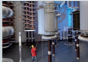
Blick in die Synthetikhalle des Schaltleistungsprüffeldes: Prüfkreise für die Durchführung synthetischer Kurzschlussprüfungen
