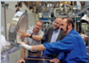
Gießharzfertigung: Qualitätsprüfung an einer Durchführung für gasisolierte Schaltanlagen
