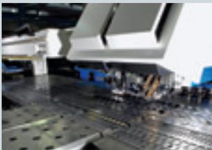
Die kombinierte Stanz-Laser-Technik sichert der Teilefertigung höchste Flexibilität und kürzeste Durchlaufzeit
