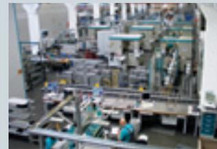
Die speziell entwickelte Montagelinie SALLIE ermöglicht die Make-to-order-Fertigung von Niederspannungs-Leistungsschaltern
