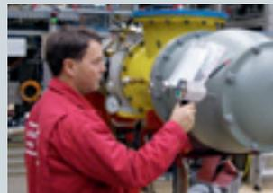
Schnüffeltest: Die Flanschverbindungen von GIS-Modulen werden auf das Entweichen von Gas überprüft. Siemens garantiert eine Leckrate von weniger als 0,5% pro Jahr
